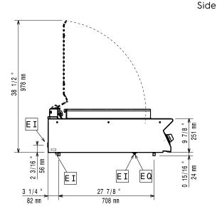
Drain ΕI Electrical inlet (power) EQ Equipotential screw
